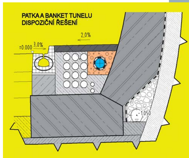
Obr. 4 Detail patky s ukončením hydroizolace
